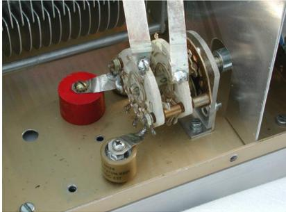
La place d'origine du commutateur d'antennes est occupée par le commutateur des capacités additionnelles à commuter pour le fonctionnement correct sur les bandes 1,8, 3,5 et 7MHz. Ces condensateurs HF sont du type « Door Knob » et maintenant on trouve facilement l'équivalent Russe (HamRadio et e-bay).
