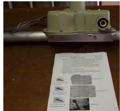
EHU fixé à la bôme au travers de sa plaque support
