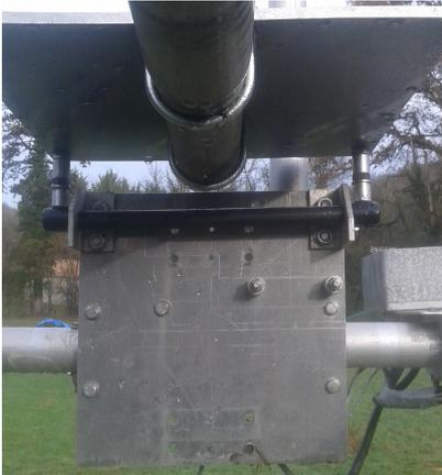
La plaque de fixation d'origine de la DB18. On distingue bien les équerres et les gongs
