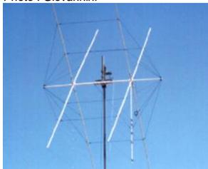
Le modèle c25/2 était conçu pour résister à des vents de 160km/h grâce à un haubannage pour le moins élaboré. Ne semble plus au programme.
